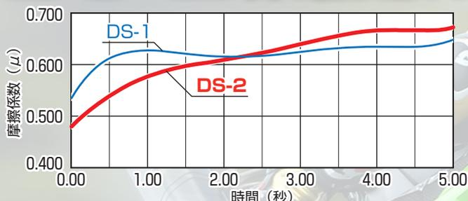
※ SBS 社でシミュレーションによる時速 310km/h から 135km/h に減速時の摩擦係数比較
