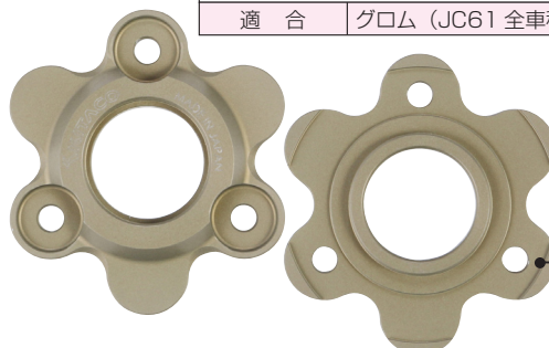
ジュラルミンを高精度に削り出し、ハードアルマイト処理を施した強化クラッチリフターの登場。
