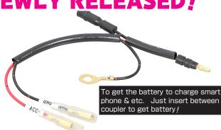
756-1311900 LUCK ¥800 ● FROM: REAR BRAKE SWITCH ● ACC ⊕・・ ACCESSORY GND ⊖・・ GROUND ● MARK TUBE INCLUDED (KITACO ORIGINAL) APPLICATION SUPER CUB C125 (JA58)
