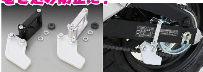
転倒時、チェーンへの巻き込みを防ぐチェーンガード。レースレギュレーションにも対応。
