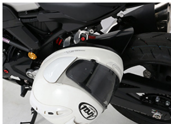
タンDEMステップ部にヘルメットロックを装着し、日常の使い勝手を向上させます!
