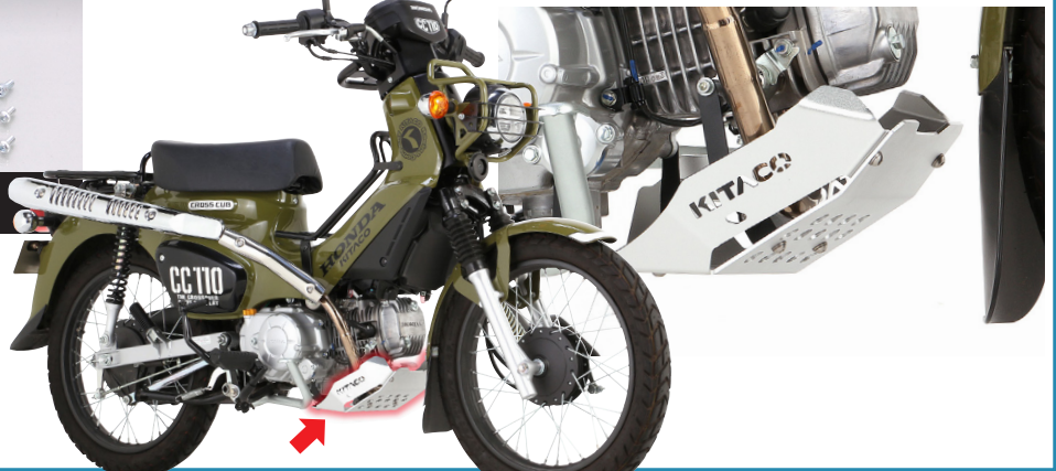
エンジン下部をドレスアップするアンダーガード。小石の跳ね上げ等からもエンジンをガードします。
