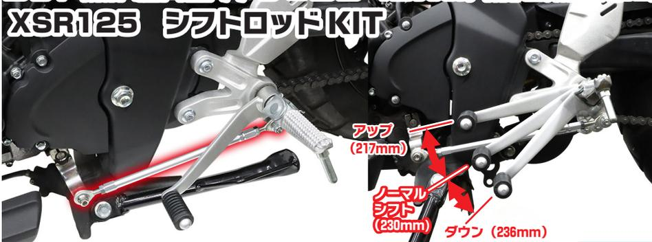
純正シフトロッドと交換することで、シフトロッドの長さを変えられるようになりチェーンペダルの高さ調整が可能になります。両端をピロボール化することにより、ガタつきが少なくなりシフトフィーリングが向上し、チェーンペダル周りの質感もワンランクアップします。ライティングポジションに合わせたチェーンペダルの角度調整により足首の負担を軽減し快適なライティングを実現します。
