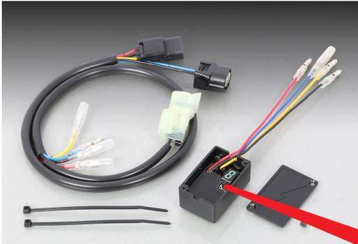
スプロケットの丁数組み合わせ変更で生じるスピードメーターの誤差を補正するアイテムです。取り付けは純正カブラーに割り込ませるだけ、ハーネス加工のいらぬカブラーオンアイテムです。
