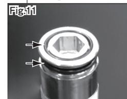
**12** フォークキャップを取り付けて、14mm六角柱で、時計回りに締め付ける。締め付トルク: 30N・m
