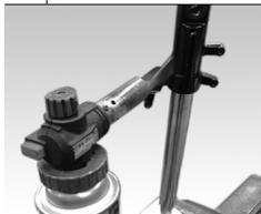
**7** ツールに付属のφ12ラウンドバーをアクスルシャフトの穴に挿し、時計回り(逆ネジ)に回してフォークブーツを緩めます。(バイスでしっかり固定し、2人での作業をお勧めします)
