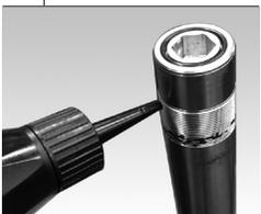
**14** フォークブーツをインナーフォークに被せてからツールに付属のΦ12ラウンドバーをアクスルシャフトの穴に挿し、反時計回り(逆ネジ)に回してブーツを締め付けます。
