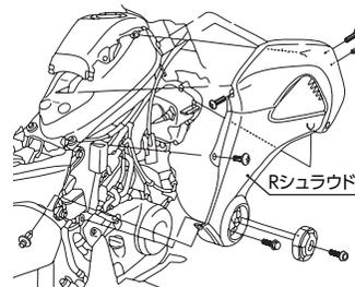
1-2 エアクリナーケースを取り外します。吸気温度 (IAT) センサーとクランクケースブリーザーホースをエアクリナーケースから外します。
