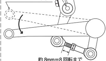
※リンクを伸ばすとシフトペダルは下がります。リンクの長さを変えてお好みの位置に調整。
