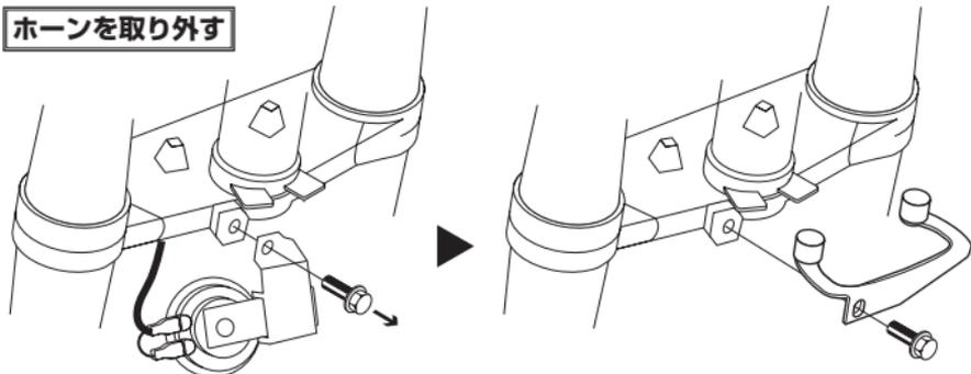
ホーン及びワイヤコネクターの接続を外す。ワイヤコネクタは絶縁処理及び、走行の妨げにならない様、処理して下さい。
