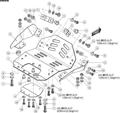
●エンジンオイルの交換は、メンテナンスリッド④を外してからメンテナスを行ってください。
