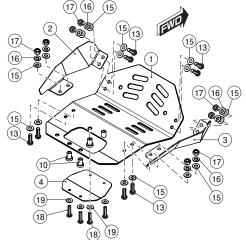
3 ※スキッドプレートを下から支えながら仮組みします。 ※アンダーフレームの全ての取り付けボルトを緩めて から装着する事をお薦めします。
