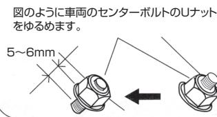
図のように車両のセンター bolt の U ナットをゆるめます。
