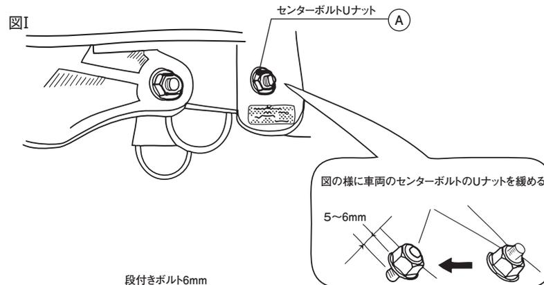
図の様に車両のセンターボルトのUナットを緩める
