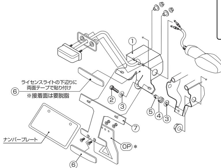
※2種ステッカーステー(OP)を使用する場合は、先にボルト(OP1)を締め付けてからリフレクター⑥を貼り付けて下さい。
