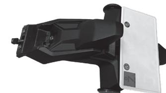
4 [Fig.4-1] ナンバープレートブラケット裏側にあるボルト2点を外して裏側のカバーを取り外します。[Fig.4-2] のように隙間に指を入れて矢印方向に引くと取りやすくなります。[Fig.4-3] 参照
