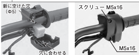
図 4 ※必ず付属のスクリュー M5x16 を使用すること。純正 (M5x20) は長さが異なるため破損します。※上側のスクリューを締め付けてから、下側のスクリューを締め付けます。[トルク：2.5N・m]
