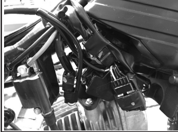
スロットルボディ①5P/②2Pカブラ (付属)カプラーオンハーネス接続状態
