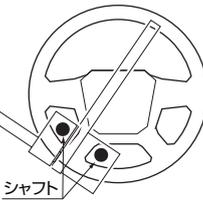
1. スポーク幅の調整は、ホーローセット (M6/イモネジ) を外し、任意の位置にシャフトを差し替えてから、再びホーローセットで固定してください。
